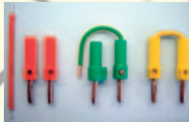
So einfach gehts – der Bau eines Steckverbinders
